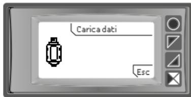
L'utente ha due possibilità, "Carica dati" caricare i parametri dalla memory o "Esc" per annullare l'operazione senza modificare la configurazione attuale.
