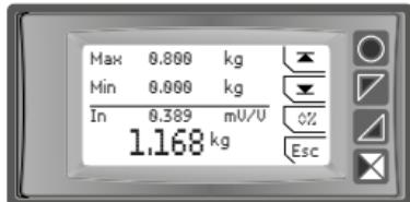
Premere "▼" per tarare il limite inferiore e "▲" per tarare quello superiore. Premere "%" per tornare alle impostazioni di percentuale di calibrazione.
