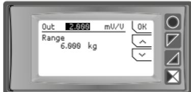
Con le frecce, impostare il rapporto mV/V dello strain-gauge corretto e confermare con "Ok".
