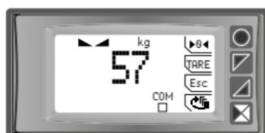
Queste funzioni, abilitate dai relativi parametri in configurazione, permettono di eseguire l'operazione di azzeramento della misura, oppure il passaggio da peso lordo a peso netto e viceversa. A questa schermata si accede dalla visualizzazione del processo, premendo uno dei tasti funzione.
