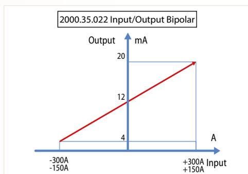
**ALIMENTACION** Loop pasivo de corriente, 11 .. 30Vdc, Protecciones para inversión polaridad y sobre temperatura.
