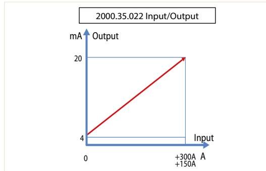
El 2000.35.022 presenta dos dip-switch a través el cual se puede configurar el fondoescala a 150 o 300A e seleccionar la función monopolar o bipolar (ver gráficos), el led amarillo colocado cerca a la bornera indica la presencia de la alimentación.
