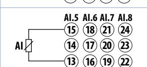
Per termoresistenze NTC, PTC, PT500, PT1000 e potenziometri lineari.
