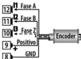
Esempio di collegamento di un encoder. Il collegamento del segnale Z è opzionale.
