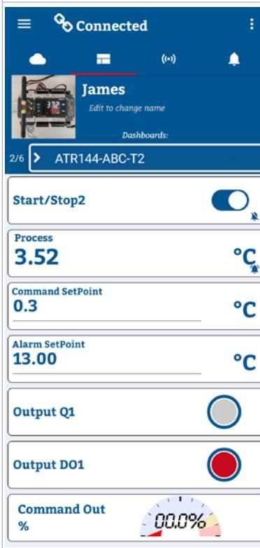
Come da immagine, le dashboards possono essere più o meno complesse e prevedere diversi controlli e valori, come pulsanti, inserimento numerico, led, selettori multipli, pannelli di stato, gauge ecc., ognuno connesso ad una diversa risorsa esposta dal CNV580 da uno degli slave collegati.
