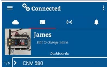
Una volta connessi ad un impianto, Pixsys Guard scaricherà la configurazione remota e passerà alla seconda scheda, “*panels*”, popolata da una serie di pannelli suddivisi in tabelloni chiamati “*Dashboards*”. Questi pannelli rappresentano lo stato di variabili modbus gestite dallo slave.
