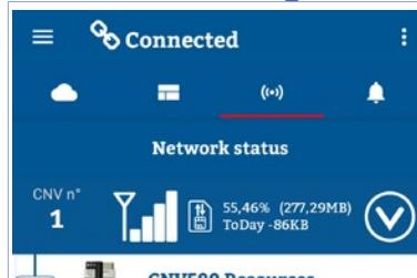
Terza schermata, mostra lo stato del CNV e delle risorse collegate ad esso. La riga in alto è dedicata allo stato del CNV580 (ID modbus, segnale di rete, traffico dati residuo e consumo odierno) e può essere espansa per rivelare numero di serie, revisione firmware, gestore e identificativo di rete, oltre ad un pulsante a destra per richiedere l'aggiornamento di tali informazioni.
