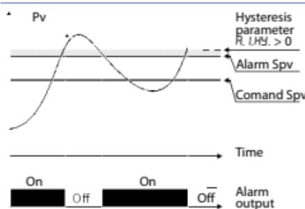
Allarme di deviazione inferiore valore di setpoint allarme minore di "0" e valore di isteresi maggiore di "0" (Par. 20 R.I.HY > 0). NB: con isteresi minore di "0" (R.I.HY < 0) la linea tratteggiata si sposta sotto il Setpoint di allarme.
