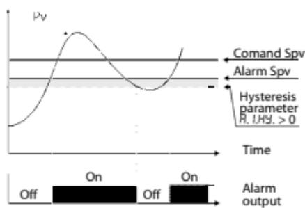
Allarme di deviazione superiore valore di setpoint allarme minore di "0" e valore di isteresi maggiore di "0" (Par. 20  $R.I.HY > 0$ ).
